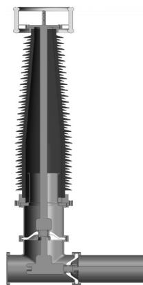
图1 GIS与套管仿真模型
